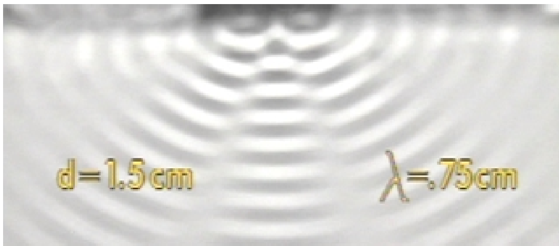
Figuur 4: Detail van interferentiepatroon uit figuur 1, met d = 1.5 cm en \lambda = 0.75 cm. De foto is op ware grootte afgebeeld.
