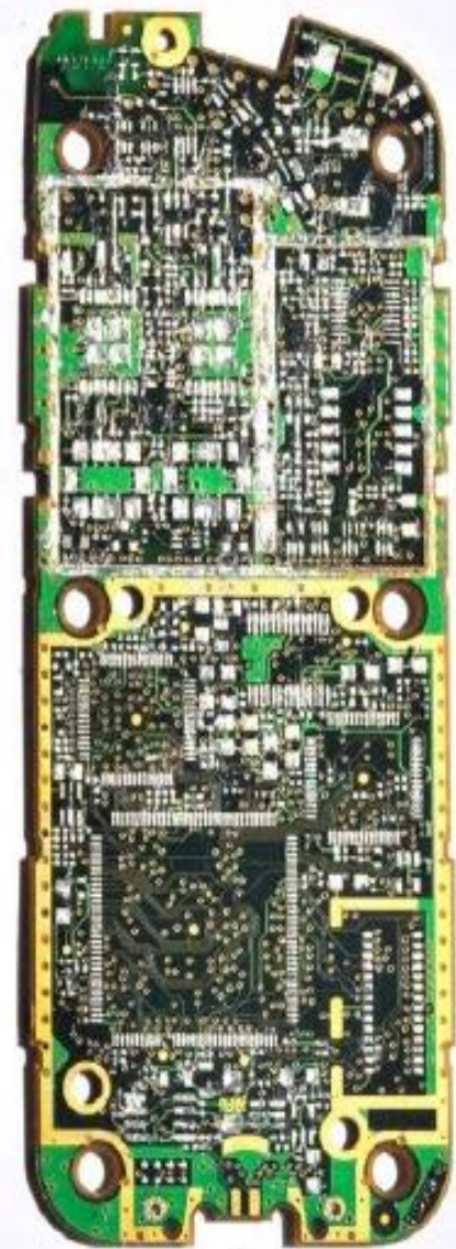
De printplaat bevat nog tin, koper en soms goud.
