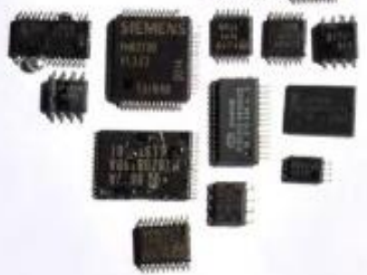
IC's (silicium in kunststof behuizingen)
