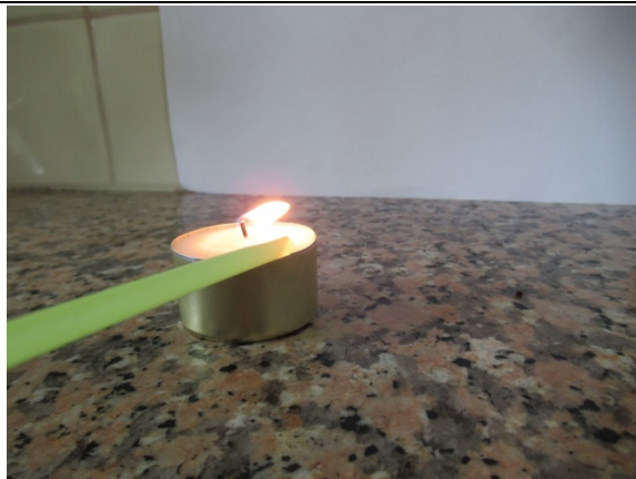
Figuur 3 Bernouilli, blazen door rietje, vlam buigt onverwacht naar luchtstroom toe.
